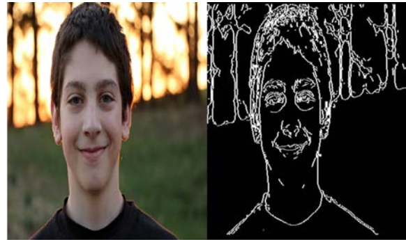
그림 5 원본 이미지(좌)와 Canny Edge Detection 으로 추출된 이미지(우)
