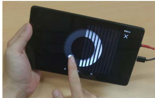
그림 2. 연구에 사용된 하드웨어. 터치 시 진동 촉감이 촉감 디스플레이로부터 발생한다.
