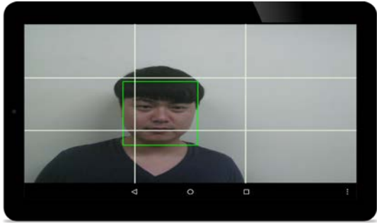
그림 4. 얼굴 인식 결과(Bounding Box) 및 화면 분할 표 1 얼굴 위치에 따른 음성 안내
