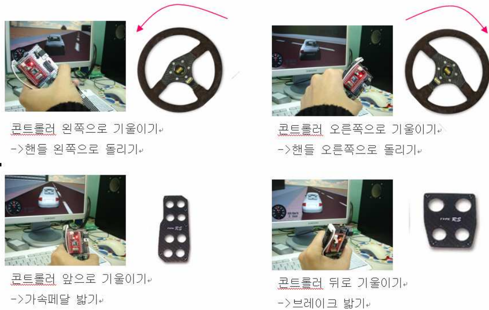
그림 20. 자동차 드라이빙 시뮬레이션에 적용된 모션 인식 방법
